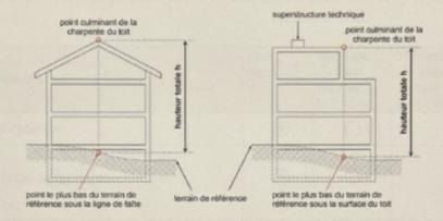
Les superstructures techniques, par exemple celles concernant les ascenseurs, les escaliers, les ventilations, les conduits de fumée ou les installations solaires peuvent dépasser le point culminant de la toiture. Les dispositions de l'Accord intercantonal harmonisant la terminologie dans le domaine de la construction (AIHC) sont applicables.
